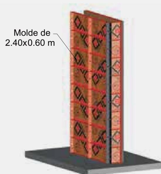
4. Se instalan los siguientes moldes de 2.40 x 0.60 m, y se ajustan moldes y corbatas con las cuñas.
